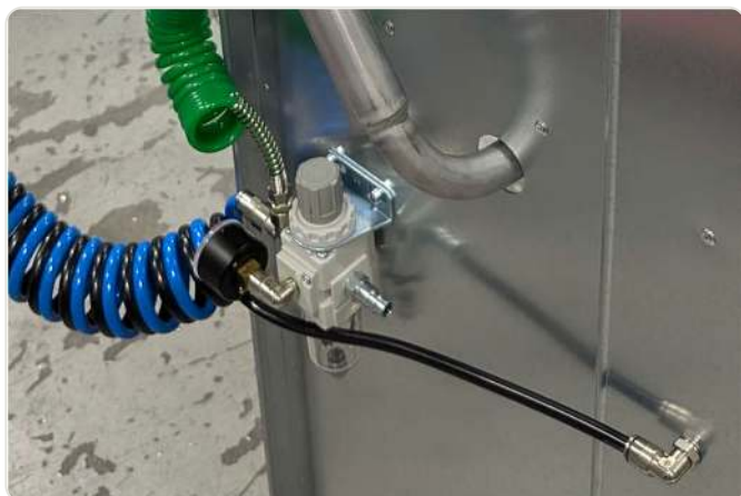
Utsida (steg 1–2): svart slang genom väggen, grön slang mot tryckluft. Röd markering = koppling.
